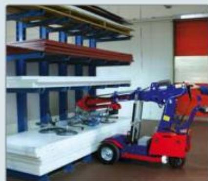
Une classe à part: la rotule pivotante/basculante électrique, qui permet de prendre les éléments lourds directement dans les étagères.
